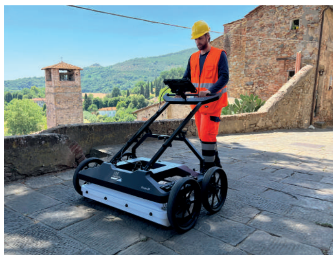
Configurazione per indagini su superfici sconnesse, 4 ruote di grossa dimensione.
