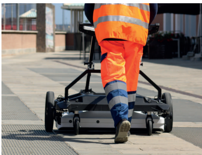
Configurazione per indagini su superfici piane, ruote posteriori pivotanti.
