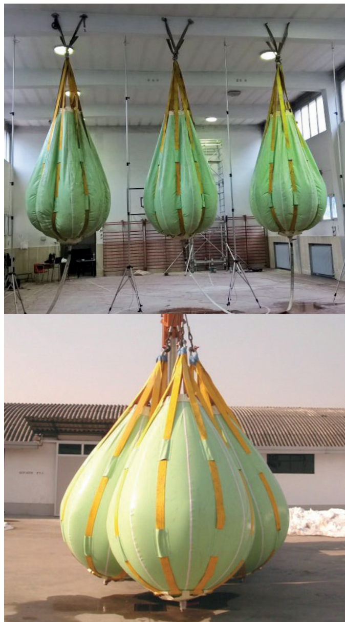
Figura 3 - Saccone per prova di carico statico.
