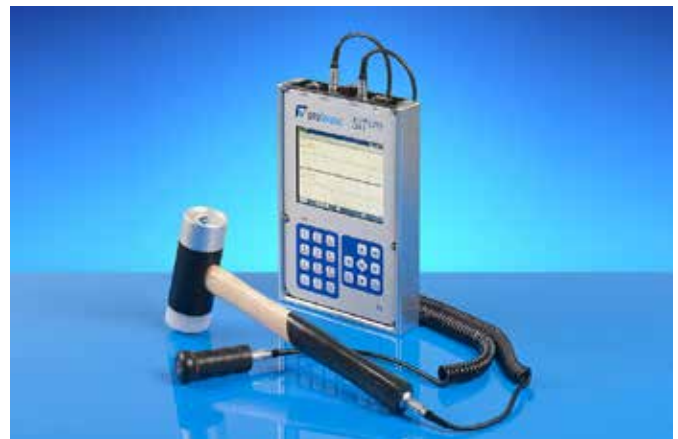
Figure 2 - Centralina SIT PRO con geofono e martello strumentato
