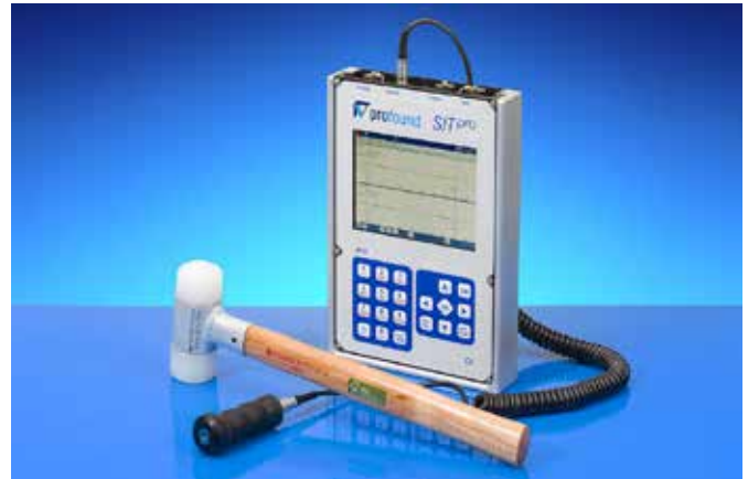
Figure 1 - Centralina SIT PRO con geofono e martello
