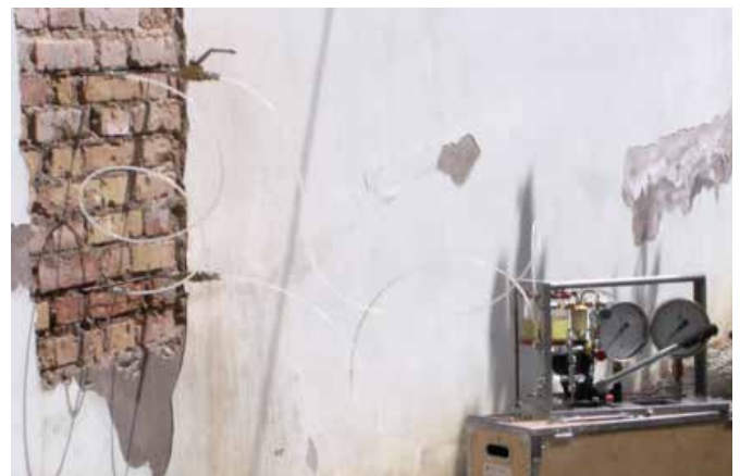
Figure 2 - Prova con martinetto doppio
