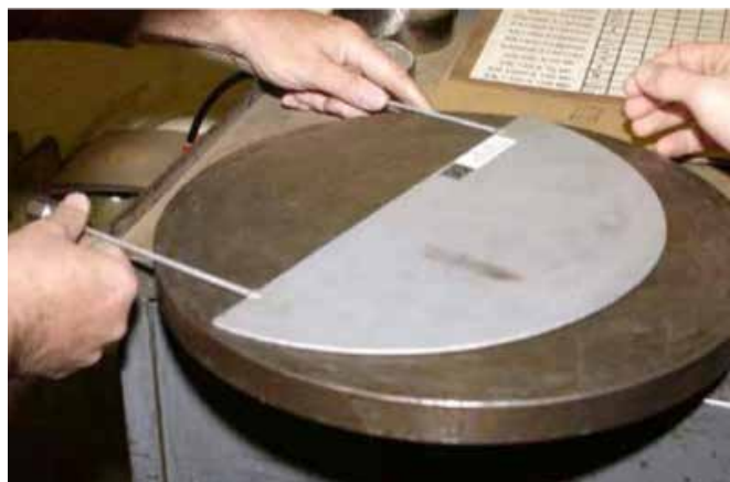
Figura 4 – Taratura di un martinetto piatto
