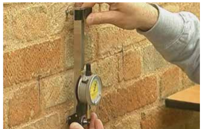
Figure 7 - Applicazione del deformometro DEMEC
