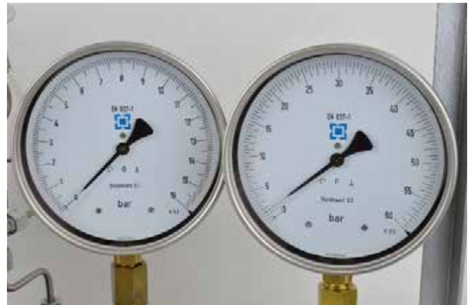
Figure 8 - Manometri di precisione della pompa M2H16
