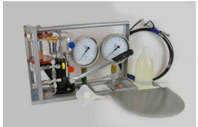
Figura 1 – Attrezzatura per prove con martinetti piatti
