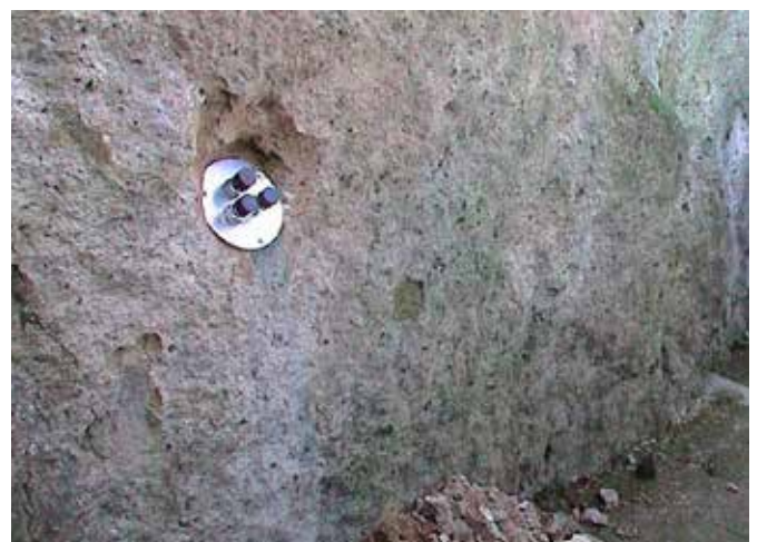
Figure 3 - Dettaglio estensimetro EA nella configurazione multi-base.
