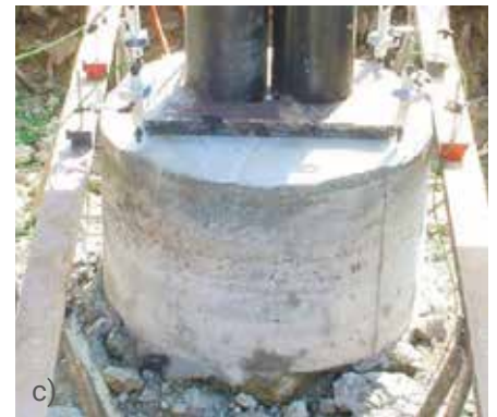
Figura 7 - a)Supporto a morsetto; b)Supporto magnetico; c)Applicazione per prova su palo;
