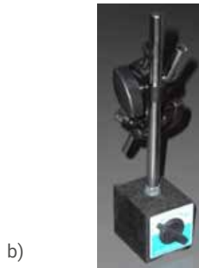
Figura 7 - a)Supporto a morsetto; b)Supporto magnetico; c)Applicazione per prova su palo;
