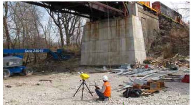
Fig. 2: IBIS-FS monitoraggio un ponte in ferro
