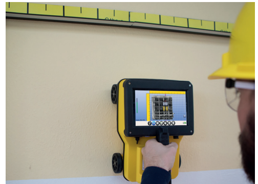
Fig.03 - Posizionamento e sistema di navigazione automatico (Virtual Pad) aumentano la produttività e riducono i tempi d'indagine.
