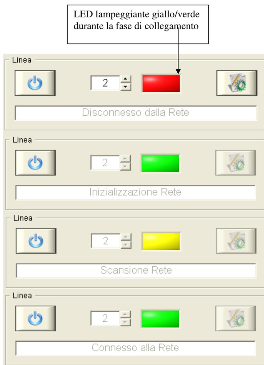
Figura 7 - Stato della Connessione
