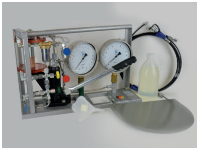
Figura 1 - Attrezzatura per prove con martinetti piatti.
