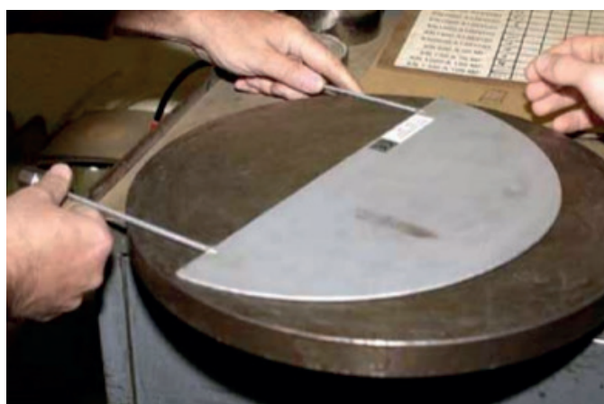
Figura 4 - Taratura di un martinetto piatto.
