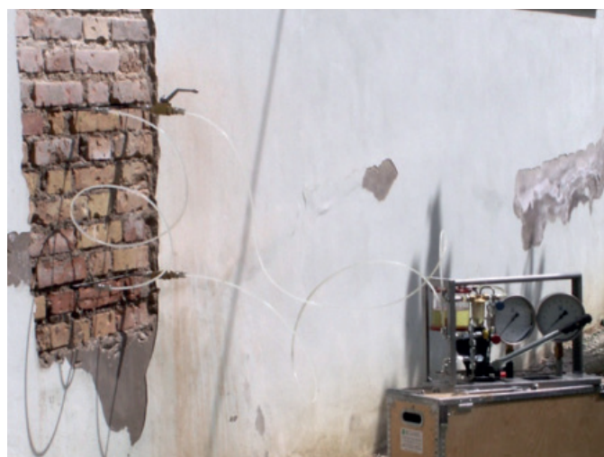
Figura 2 - Prova con martinetto doppio.
