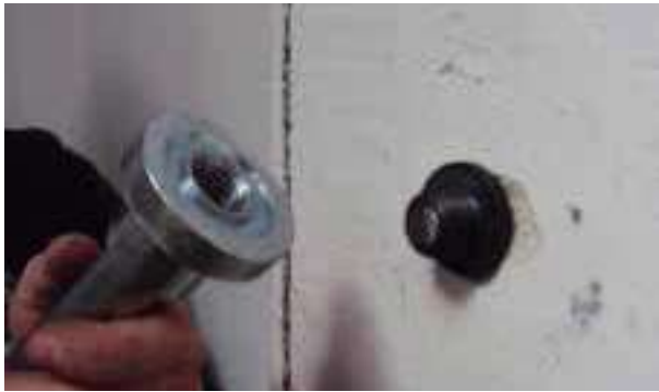
Fase 7: avvitamento dello stelo estrattore del martinetto oleodinamico alla filettatura del tassello
