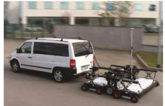
IDS introduce la tecnologia **STREAM**: array di antenne multi-frequenza e multi-polarizzate per grande precisione e altissima produttività.
