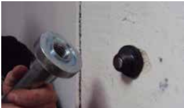
Fase 7: avvitarlo dello stelo estrattore del martinetto oleodinamico alla filettatura del tassello
