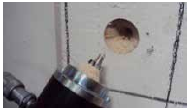
Fase 9: esecuzione della prova ed estrazione del frammento conico
