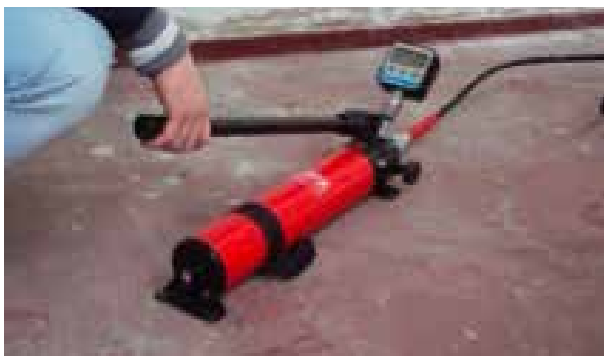
Fase 9: esecuzione della prova ed estrazione del frammento conico
