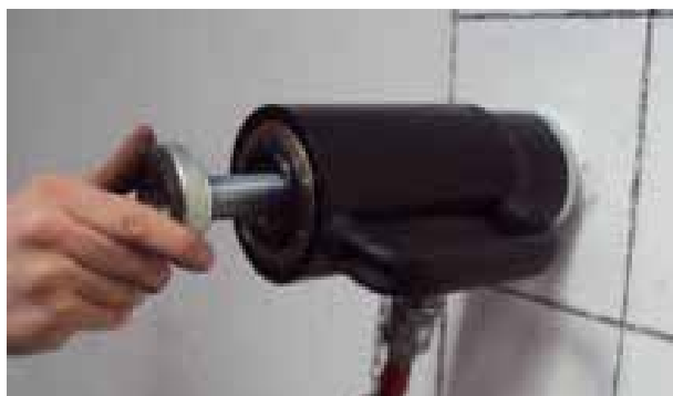
Fase 8: posizionamento e fissaggio del martinetto e collegamento del tubo idraulico alla pompa
